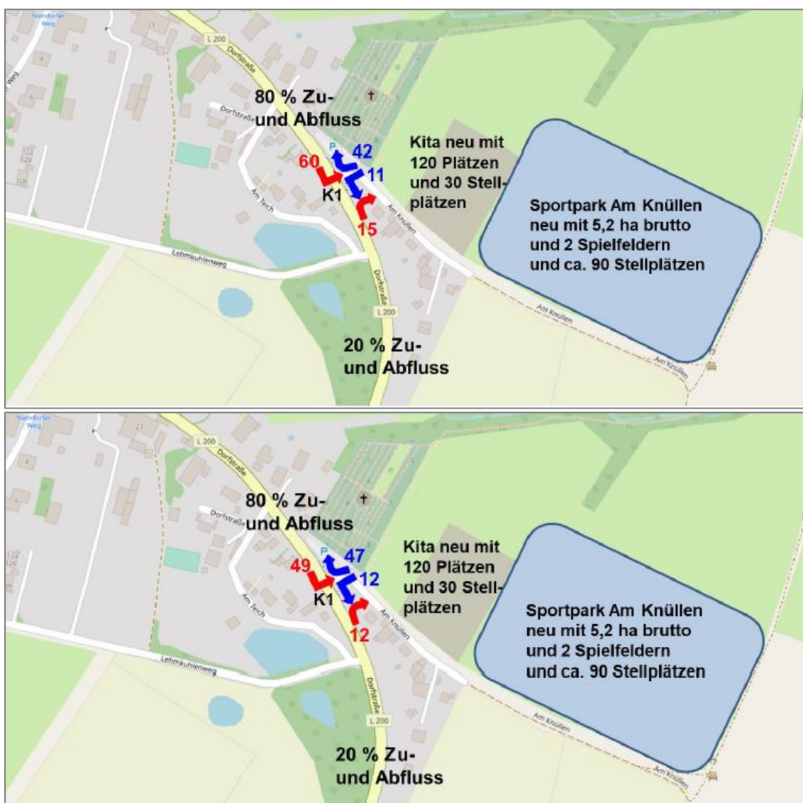
Abb. 7: Verkehrsverteilung (Bestand) in der morgendlichen Spitzenstunde (oben) und der nachmittäglichen Spitzenstunden (unten) [rot = Zielverkehr; blau = Quellverkehr]
